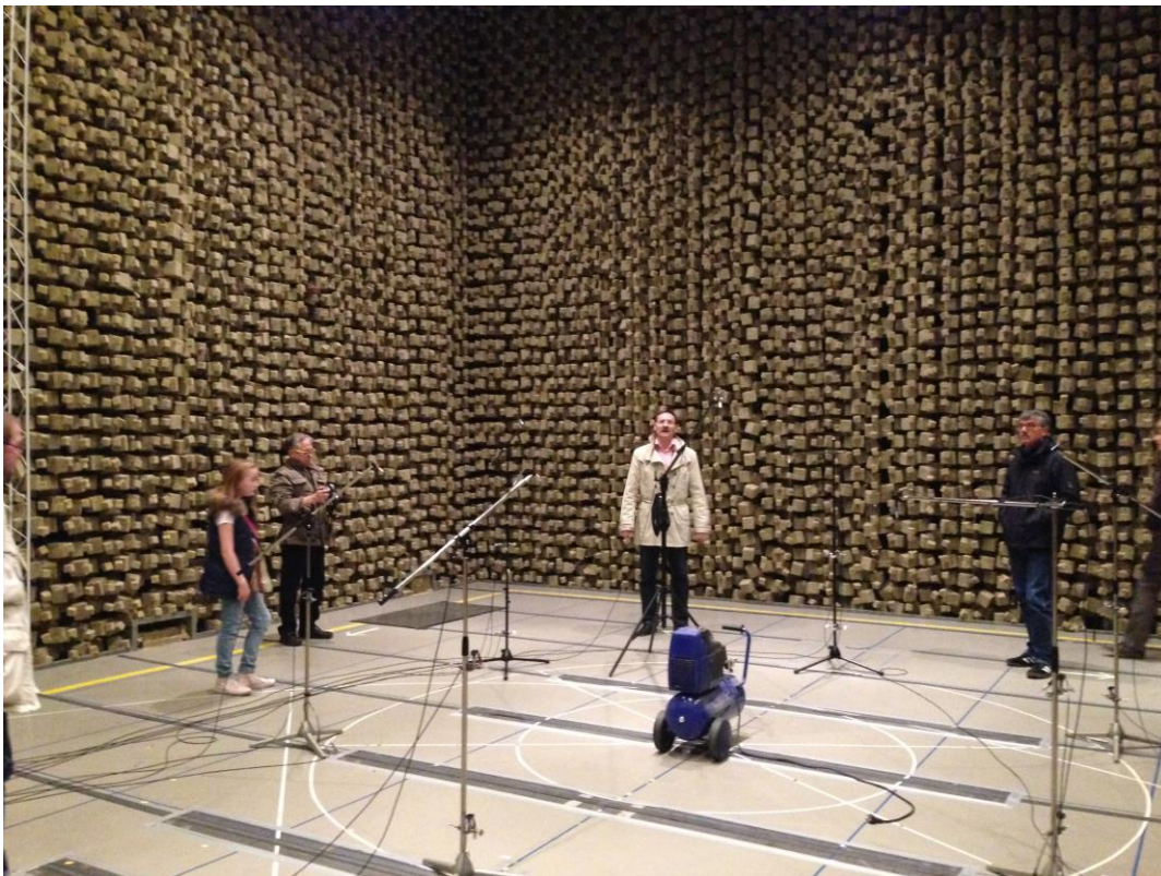
Lärmlabor mit 1,5 m dicken Schallschutzwänden
